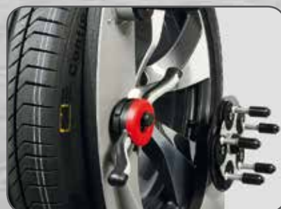
Die ergonomisch angebrachten Spann- und Zentrierwerkzeuge können mit nur einem Griff von der Halterung entnommen werden.
