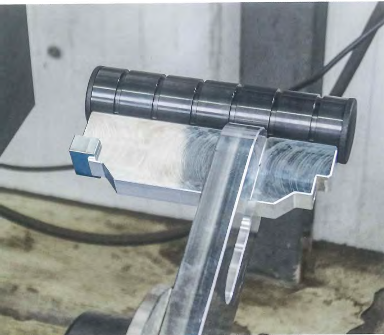
In unserem Prüfbeispiel wurde ein 60-g-Prüfgewicht an der Prüfvorrichtung angebracht.
