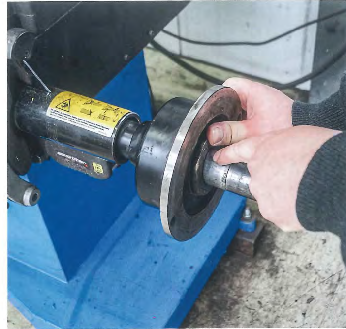
Im Bereich der automatischen Aufspannvorrichtung hat die Mittelwelle den höchsten Verschleiß.
