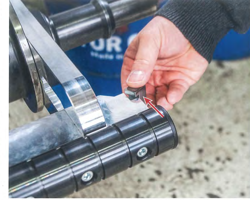
Zur Überprüfung der statischen Wucht wird das magnetische Messgewicht (Pfeil) einfach an der Prüfvorrichtung im Bereich „Felgenmitte“ angebracht.
