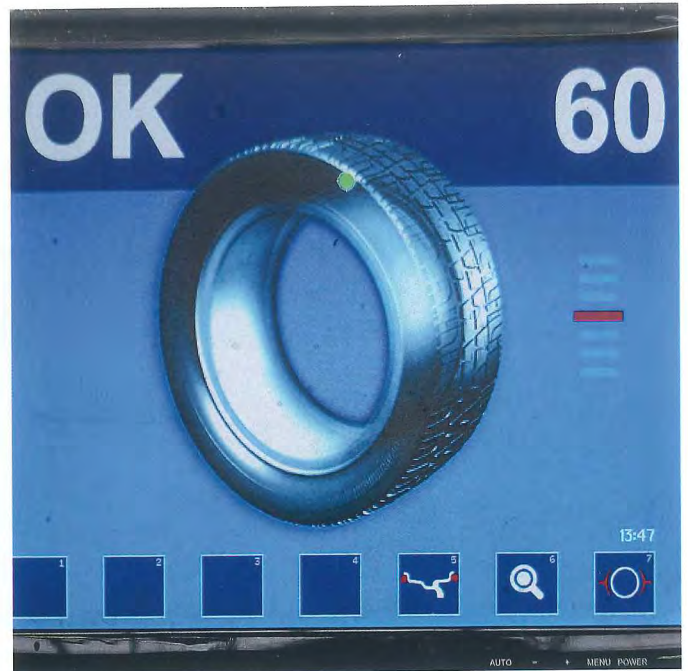
Die Kalibrierung mit dem 60-g-Prüfgewicht erbrachte das gewünschte Ergebnis.
