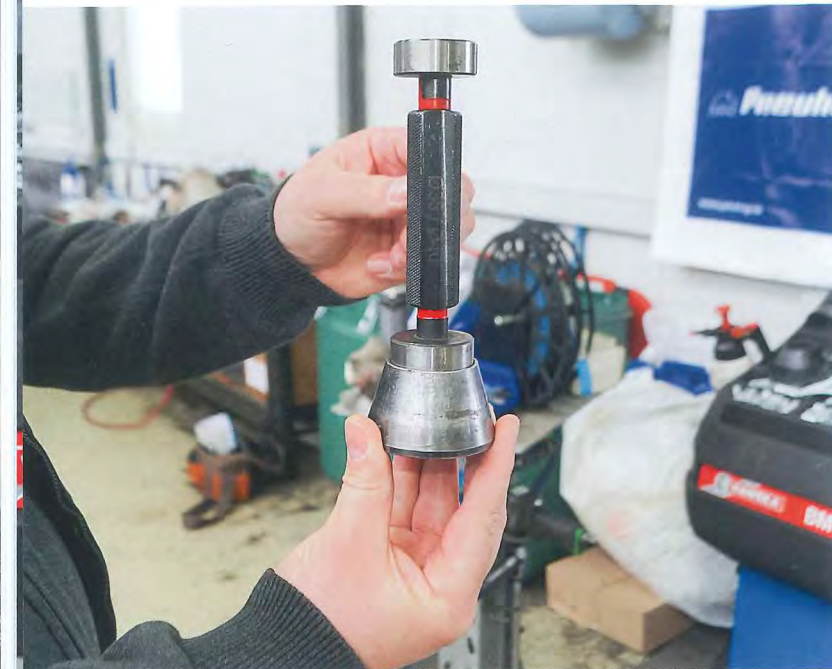
Ob der Konus zum Zentrieren und Aufspannen vom Verschleiß her noch im Soll liegt, zeigt der Messdorn.
