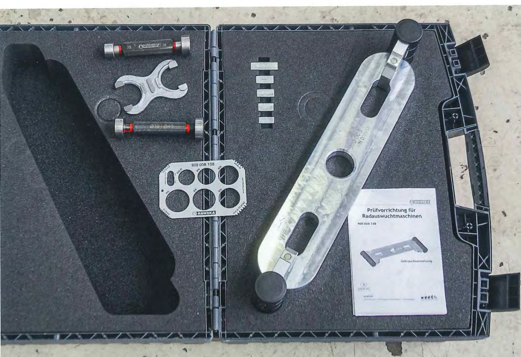
Im Prüfkoffer sind der Prüfbalken und Messgewichte enthalten. Messdorne, Messgabeln und Wellen- oder Gewindelehren können optional bei Haweka erworben werden.
