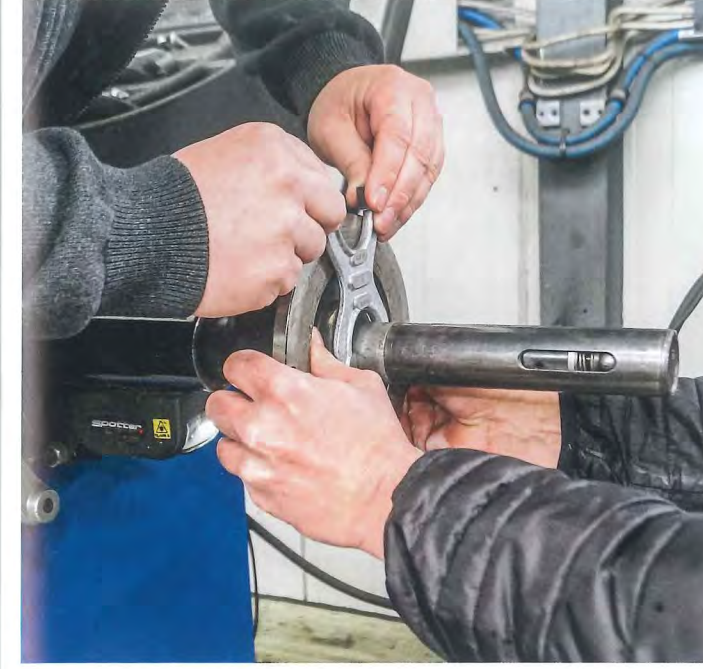
Um Verschleiß bei der automatischen Aufspannvorrichtung auszuschließen, muss mit der Messgabel nachgemessen werden.
